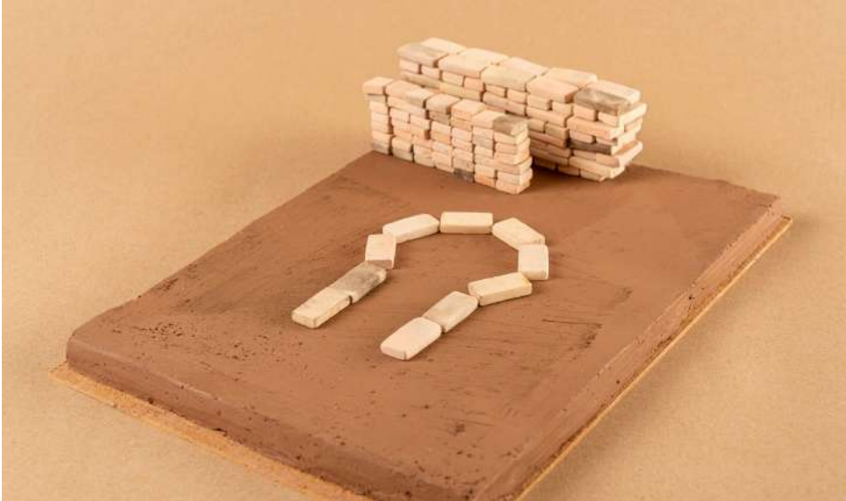
Foto 1. Armado de la planta del horno. Ejemplo para horno pequeño o mediano.
