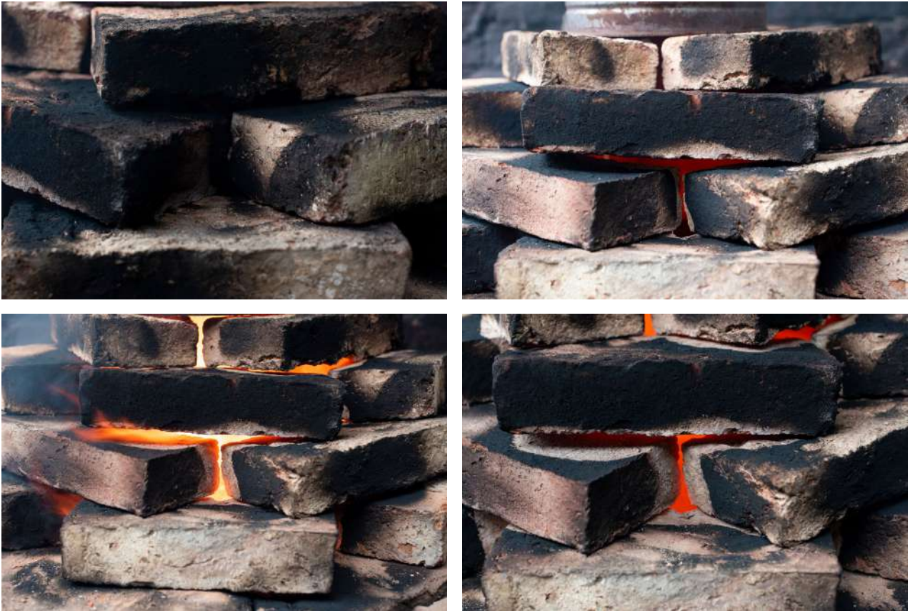
Foto 27 a 30. Cambio de color en los bordes de los ladrillos durante la horneada.
