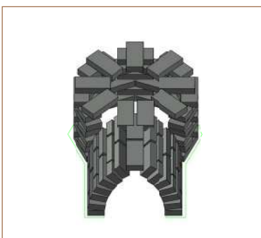
fig 6. Plano del apoyo de la parrilla o piso de la cámara de cocción
