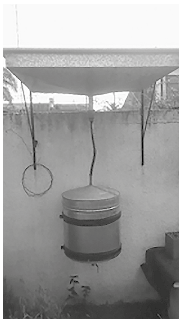
Figura 1. Fotografía del Dispositivo Muestreador.
